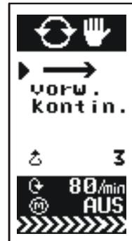
**Die Abfülldüse ist bei jeder Art des kontinuierlichen Pumpens zu entfernen.** Sie wäre ein zu großer Widerstand in der Rohrleitung und würde dabei eventuell beschädigt. Auch der Motor könnte überlastet werden.
